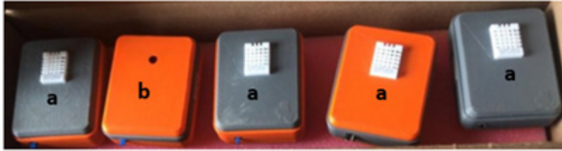
Figura 2. Dispositivos de registro interno; (a) temperatura y humedad y (b) registro externo presión.
