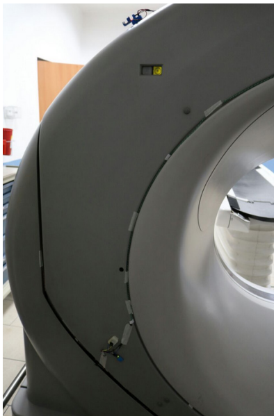
Figura 3. Área de ubicación de los sensores de sonido y vibración para la detección de anomalías de funcionamiento.
