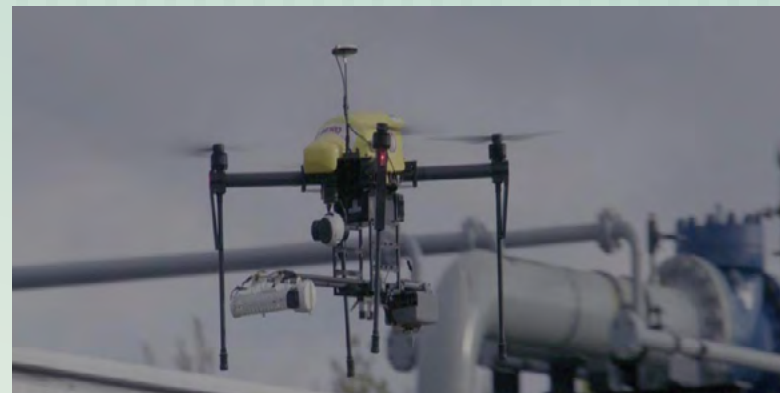
Figura 1. Vuelo de un dron sobre un gasoducto para detectar fugas (Fuente: Utah Aerial Drones).
