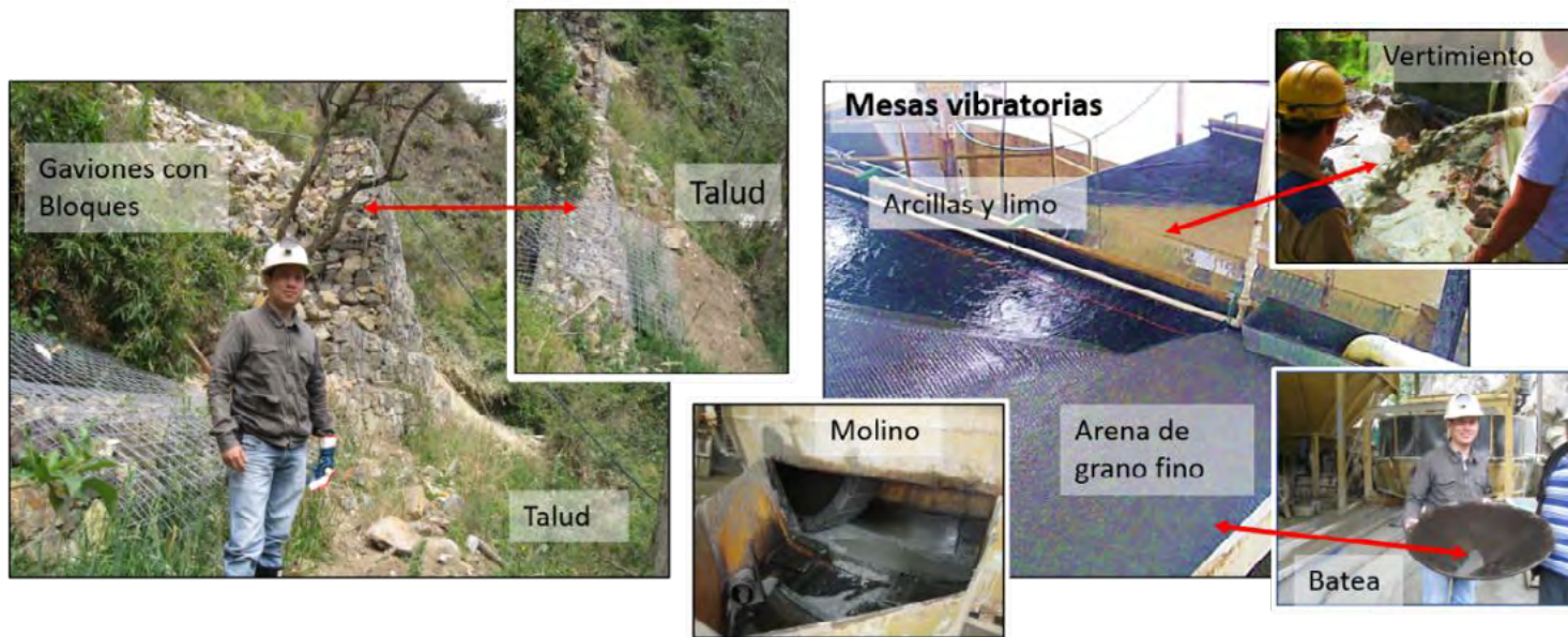
Figura 2. Separación de residuos estériles y agregados.
